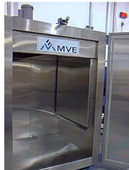
Rysunek 7. Rozwiązanie konstrukcyjne komór kriogenicznych stosowanych w obróbce podzerowej [3].
