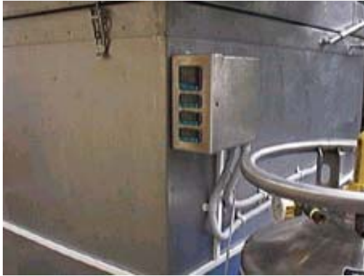
Widoczny zbiornik LN2 o ciśnieniu 16 bar
