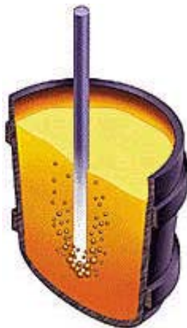
Rysunek 11. Przedmuchiwanie ciekłych metali gazami.
